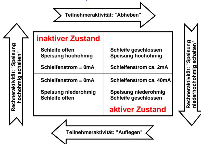
Bild 10 Hardwarezustände einer Teilnehmerschaltung
