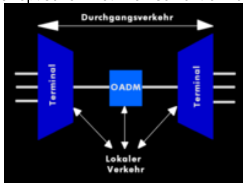
Bild 30 Funktion des Add/Drop-Multiplexers OADM
